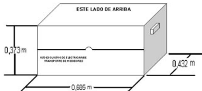
Figura 1. Características y dimensiones de la caja de medidores
